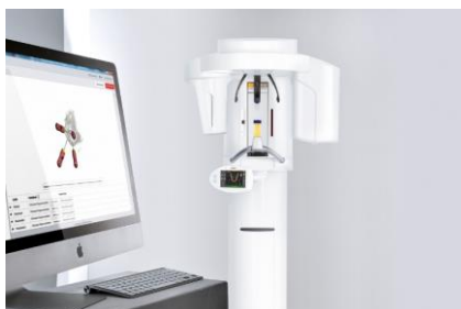
Abb. 1: Mithilfe von 3D-Röntgendaten eines Orthophos SL lassen sich in der 3D Endo-Software Endodontiebehandlungen planen und optimieren.
