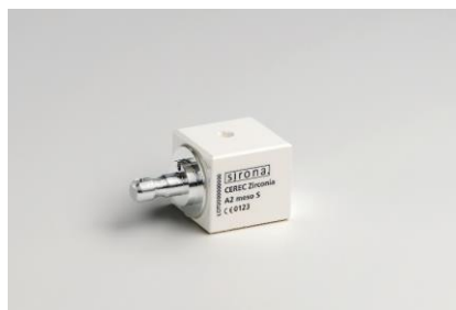
Abb. 14: Die neuen CEREC Zirconia Meso Blocks besitzen vorproduzierte Bohrungen für TiBase-Schraubkanäle und erleichtern so die Fertigung von direktverschraubbaren Kronen.
