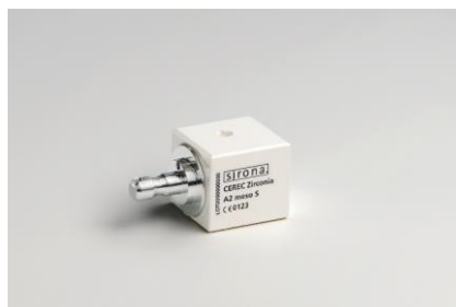
Fig. 14 : Les nouveaux blocs CEREC Zirconia Meso comportent des trous de forage préfabriqués pour les canaux de vis TiBase, facilitant ainsi la production de couronnes transvissées.
