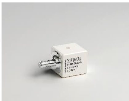
Fig. 3 : Les nouveaux blocs CEREC Zirconia Meso comportent des trous de forage préfabriqués pour les canaux de vis TiBase, facilitant ainsi la production de couronnes transvissées.
